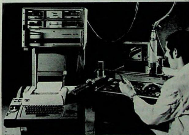
Programmeren van een boormachine voor het boren van printplaten (foto: Grundig).
